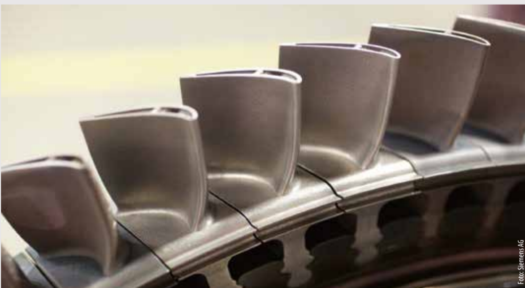
Tragfähig: Mit 3D-Druck will Siemens Prototypen schneller herstellen. Erstmals hat der Konzern eine Turbinenschaufel unter Volllast eingesetzt, die komplett aus dem Drucker kommt.
