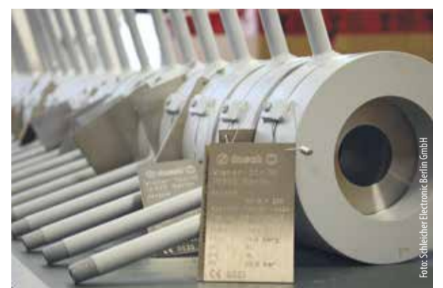
Steter Tropfen: Solche Differenzdruckgeber von Dosch messen, wieviel Gas oder Flüssigkeit durch ein Rohr geflossen ist.
