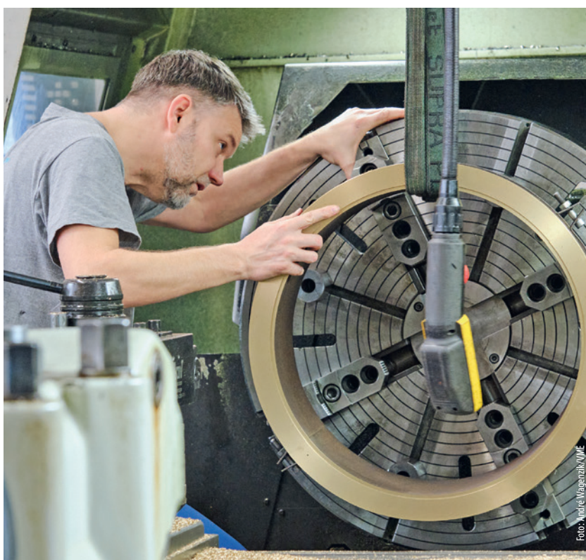
Millimeterarbeit: Präzision und Tempo stehen bei KST ganz oben. Hier arbeitet ein Beschäftigter an Abdichtungskomponenten für einen gasgekühlten Generator.
