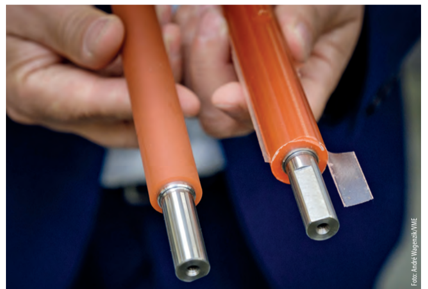
Alles dreht sich: Auf Produkte wie diese Vorschubwalzen für Hochleistungs-Etikettiermaschinen sind die Rückerts stolz. Rechts steckt die Rolle in einem Zwischenstadium, links das Endprodukt.
