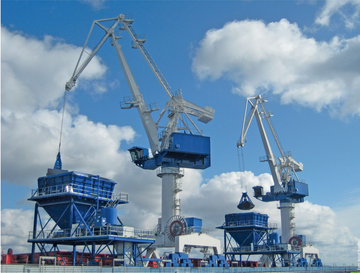
Gewichtheber: Mehr als 100 Tonnen können Kräne von Ardelit an den Haken oder auf die Schippe nehmen. Sie werden beim Umschlag von einzelnen Lasten und von Schüttgut eingesetzt. XXL-Ausführungen kommen auf eine Höhe von mehr als hundert Metern.
